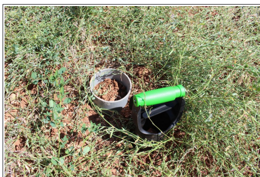
Figure 5 : LI-COR 6400-09 et sa chambre de mesure et collier PVC installé en amont de la mesure
