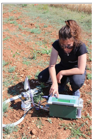
Figure 5 : LI-COR 6400-09 et sa chambre de mesure et collier PVC installé en amont de la mesure
